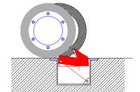
Der **Einbaurahmen** Ist eine Stahlschweißkonstruktion mit den erforderlichen Lagerstellen der Betätigungsmechanik und der Sperrsegmente. Der Rahmen wird in den bauseitig vorbereiteten Aushub eingesetzt, der Straßenneigung angepaßt und anschließend mit Bn eingegossen.
